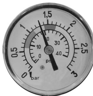
1,3 kg/cm 2 - 18,5 PSI: Questa pressione indica che è necessario procedere al LAVAGGIO.
