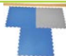
5. Для верной стыковки половиц, следует уложить модуль и, надавливая пальцем, состыковать угловой элемент замка половицы. Затем, ударами резиновой киянки состыковать остальные элементы, продвигаясь в направлении от угла половицы к её краям.
